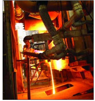
Fritas - Boca de salida de fritas fundidas del horno
