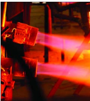
Boca de salida de fritas fundidas del horno y quemadores de boca
