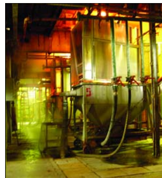
Fritas - Sistema de fritado en agua con tornillo de transporte a la balanza
