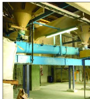
Transportes automatizados de materia prima almacenada en los silos hacia la balanza
