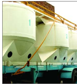
Camiones tolva abastecen los silos de materia prima de alto consumo mediante transporte neumático
