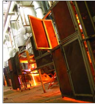
Fritas - Boca de salida de fritas fundidas del horno
