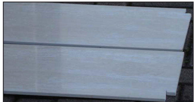
Piastrelle uguali, in gres porcellanato, macchiate di Coca Cola, dopo un minuto di contatto: su quella in alto, trattata con Metpick, la macchia è invisibile; su quella in basso, non trattata, gli effetti dell'aggressione sono ben evidenti.
