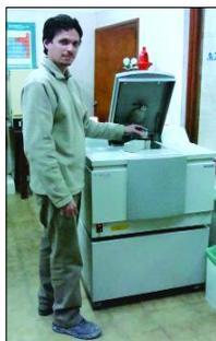
Equipo XRF para arcillas y caolines
