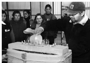
Llenado de una matriz para moldes de alta recuperación.
