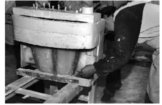
Preparación de la matricería para llenado con yeso especial para colado a presión.
