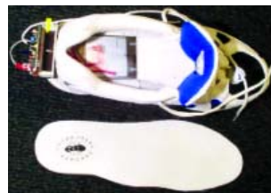
Fig. 1. Zapatilla con recolector piezoeléctrico en la zona del talón, con rectificador adosado y circuito transmisor de RF que emite un código identificador (prototipo). Kymissis et al. (ref.7)
