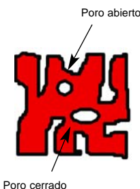
Figura 1. Esq. de un sólido mostrando poros abiertos y cerrados.
