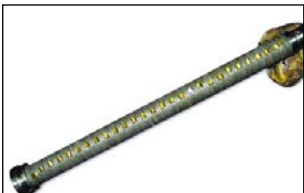
Fig. 2. Uno de los 9 elementos del piezogenerador de fondo de pozo petrolero construido para Serv. Esp. San Antonio S.A. (R.E.Juárez).
