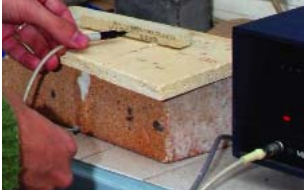
Demostración del funcionamiento del equipo para la medida de las constantes elásticas por la técnica no destructiva de excitación por impulso.
