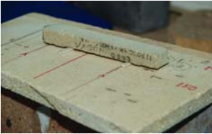
Probeta de un refractario sílico-aluminoso siendo ensayada por la técnica de excitación por impulso.
