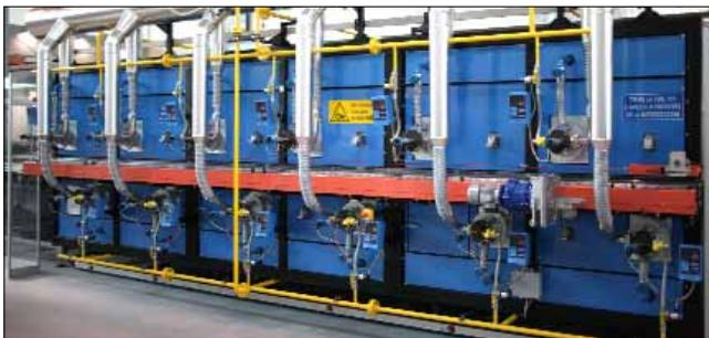
disminución del uso de combustible. El consumo no es lo único que permanece constante en estas condiciones: la presión, la temperatura también son estables y la curva de cocción está bajo control en todo el horno, incluso en caso de vacíos de producción.
