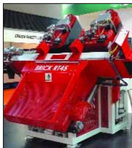
**Abrasión:** Los dos módulos de la línea de rectificadado trabajan con bandas abrasivas en seco, sin provocar daños aún en los sectores más delgados (4-5 mm) aunque presente fisuras en la salida del secadero. La elaboración en seco simplifica el proceso productivo ya que permite llevar el producto desde la línea de rectificadado hasta la apiladora del carro del horno sin agregar otros pasos.
