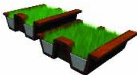
El proyecto consistió en un sistema de techado verde para el cual se presentaron 3 piezas modulares que contienen césped con un sistema de filtrado. Las piezas no necesitan moverse y pueden ensamblarse fácilmente. Trabaja del mismo modo que con las tejas estándar y por lo tanto no necesita alterarse para los sistemas de arquitectura moderna y puede adaptarse fácilmente a cualquier clase de techos de viviendas.
