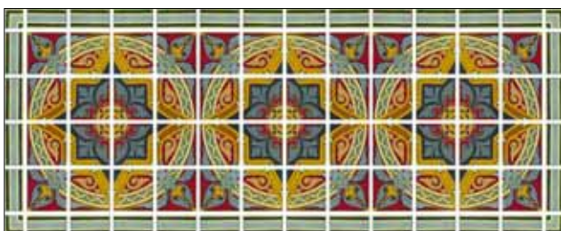
Piso V&B del Congreso de la Nación, al que se agregó una grilla blanca para destacar las piezas componentes de 6\frac{3}{4} x 6\frac{3}{4} (17,1cmx17,1cm). Obsérvese la similitud de colores empleados en el piso de la Catedral de Colonia.
