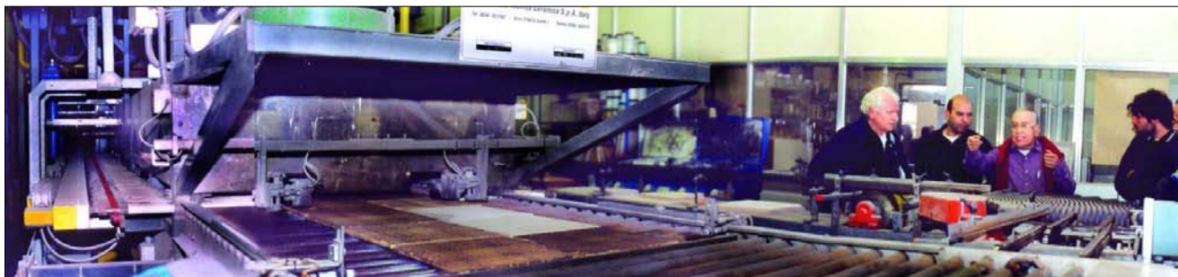
Foto superior e inferior. Vistas de la salida de los revestimientos del horno de rodillos
