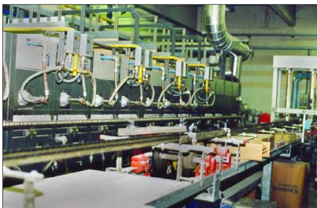
Vista parcial del horno piloto de Ferro Argentina, quemadores y conexiones.
