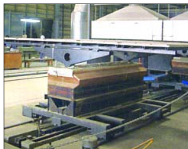
Vagoneta Gemini con estructura en SiSiC.
