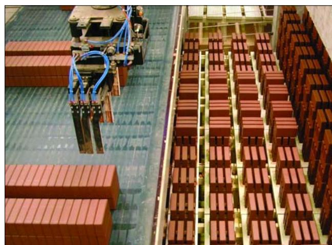
*Un encaje exacto es requisito para un buen resultado en el secadero Meandro*
