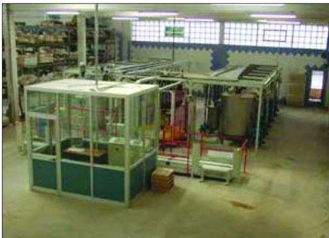
L'impianto può essere ad uno o due piani e può essere corredata di etichettatrice manuale od automatica, di agitatore automatico autopulente e di rulliera motorizzata per il carico e l'accumulo di più preparazioni in serie.
