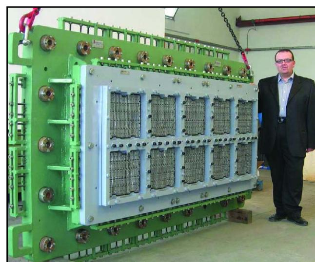
El sistema Ero® que funciona desde el 2002 fue evolucionando ulteriormente hasta el año pasado, cuando se puso en marcha un nuevo sistema en una cerámica de Francia, en la cual se producen bloques con paredes muy finas cargando de un solo golpe la bandeja del secadero de arriba hacia abajo.
