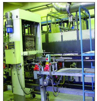
Planta Piloto - Horno a rodillos para desarrollos cerámicos y control de calidad de producto terminado
