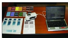
fig.3. Espectrofotómetro con software especial, que permite optimizar el desarrollo de color, racionalizando el consumo de pigmento.
