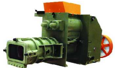
Vista general del embudo. Obsérvese el sistema de soporte articulado para facilitar el desarme de la boquilla.
