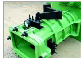
Vista general del embudo. Obsérvese el sistema de soporte articulado para facilitar el desarme de la boquilla.
