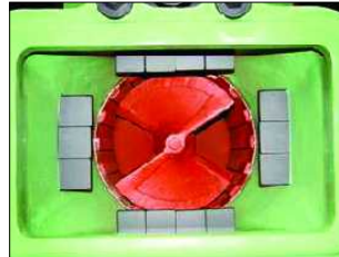
Vista frontal del embudo con regulaciones exteriores
