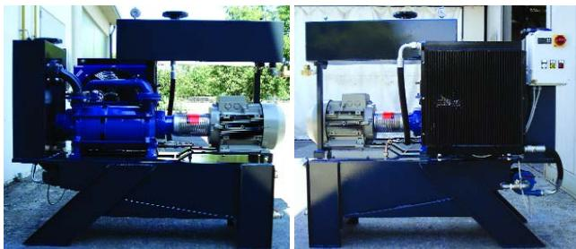
Unidad de vacío a recirculación total de aceite OCS 5/15 VFa.
