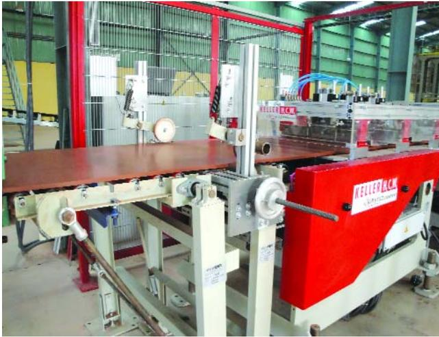
Estampadora de precisión para las placas de extrusión planas
