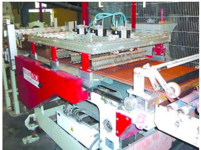
Troqueladora de precisión para la producción de 2 x 300 mm, ó de 1 x 600mm
