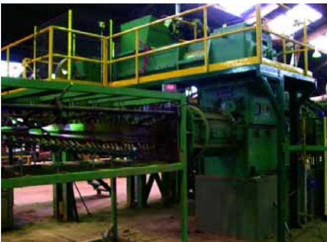
Extrusora Tecno 550 con desgasificador MIX 510/D
