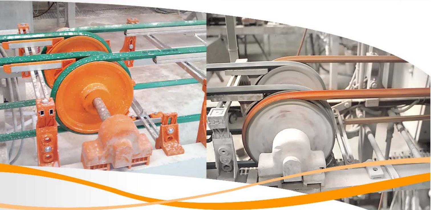
Caucho y poliuretano son materiales esenciales para el transporte de todos los productos en el campo de la cerámica. Es suficiente pensar en las bandas transportadoras de caucho para las materias primas, las bandas de PVC para la salida del horno y las correas de goma para la manipulación de productos semi-elaborados y productos finales.
