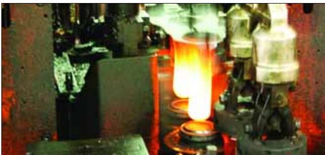
Ingreso de la gota al molde que aún no se ha cerrado.(zona caliente). El horno 7 será igual.
