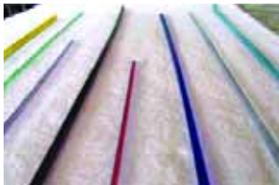
Varillas de vidrio estirado para trabajar a soplete.
