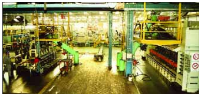
Zona caliente donde se observan dos máquinas de producción, la de la derecha es un IS de 12 secciones.
